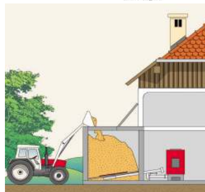
Hackgutaustragung mit angebautem Lagerraum
