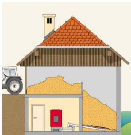
Hackgutlagerung über dem Heizraum
