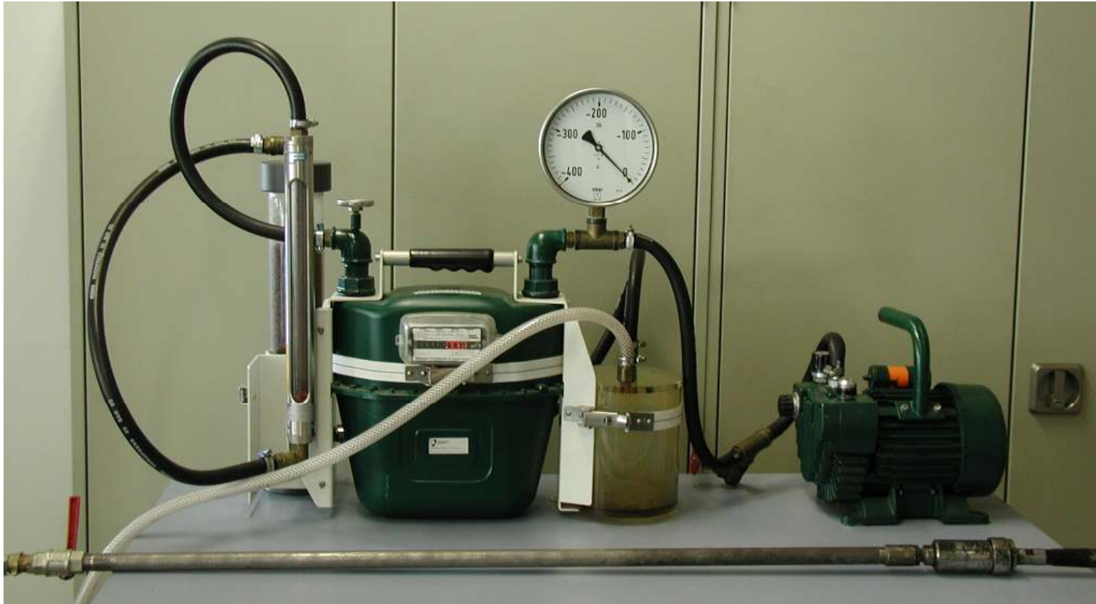
Staubmessgerät STE 4 der Fa. Stroehlein für isokinetische Probenahme mit Sonde, Gaszähler und Kompressor
