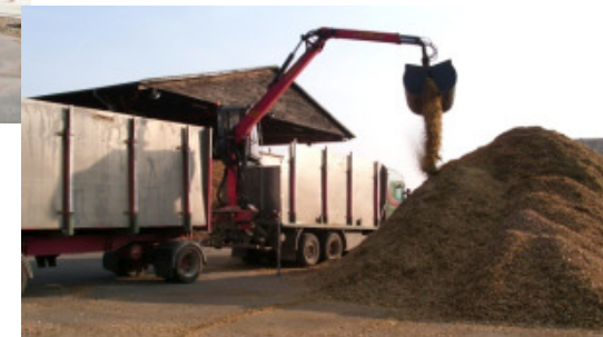
umgebauter Kurzholz- transporter: 70 m 3
