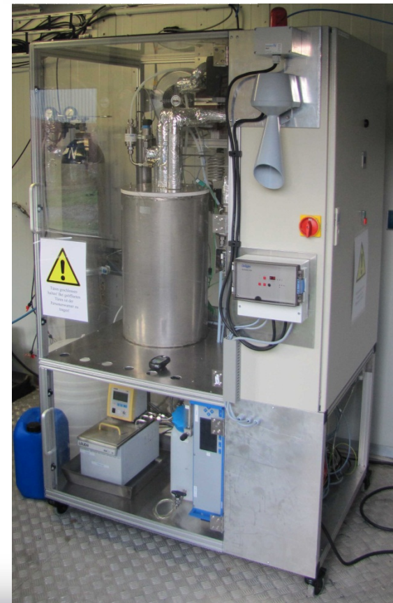
TÜV-geprüfte Anlage (V H 2 = 3 m 3 N /hr)
