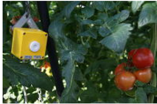
Foto 7: Ein Sensor mitten in der Kultur misst die Ethylen-Konzentration und gibt die Daten an den Regelanlage weiter
